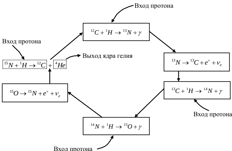
Рис.2. В CNO-цикле является ^{12}\text{C} . В нем 4 протона преобразовываются в ядро гелия, 2 позитрона, 2 нейтрино и излучение. Этот цикл является доминирующим источником энергии для звезд более массивных, чем 1.5M_{\odot} .
